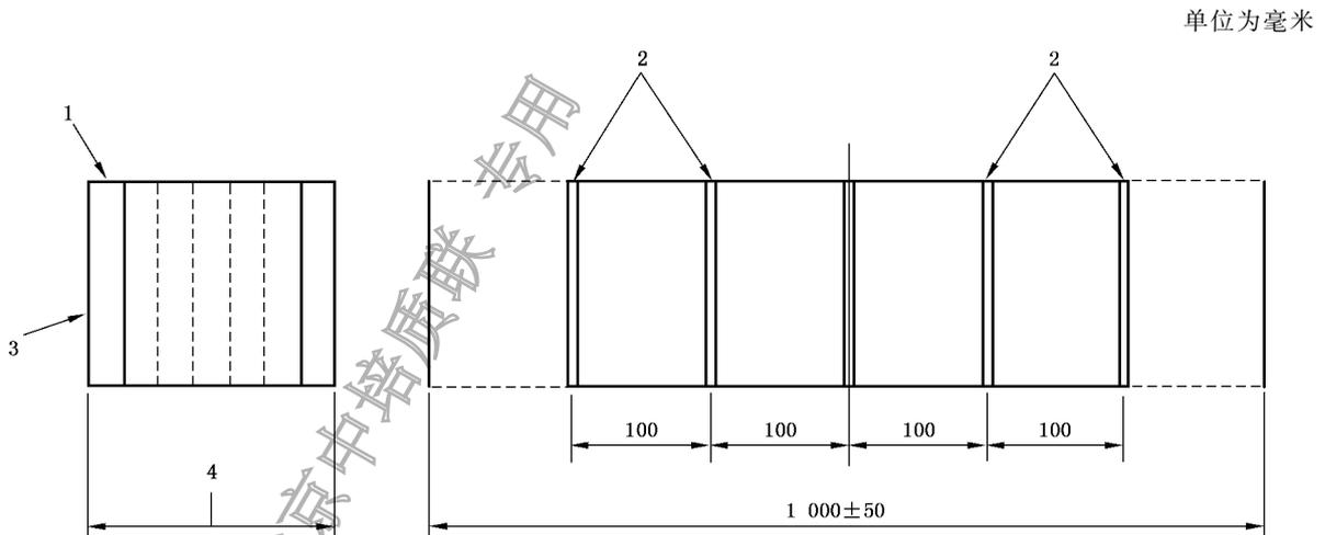
图 2 非圆形电缆或光缆水平扁型单元的绑扎方法
