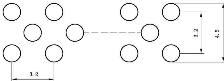
注: 在燃烧器喷火面板上的中心区域,孔径 1.32 mm,中心距 3.2 mm 的圆孔,分三排交错排列,燃烧器喷火面的标称长度为 500 mm。
