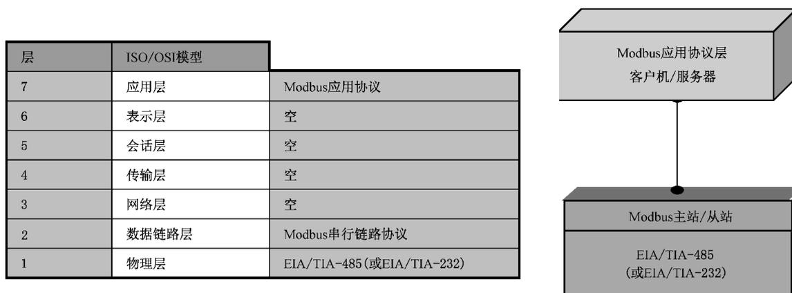
图 A.2 Modbus 协议和 ISO/OSI 模型
