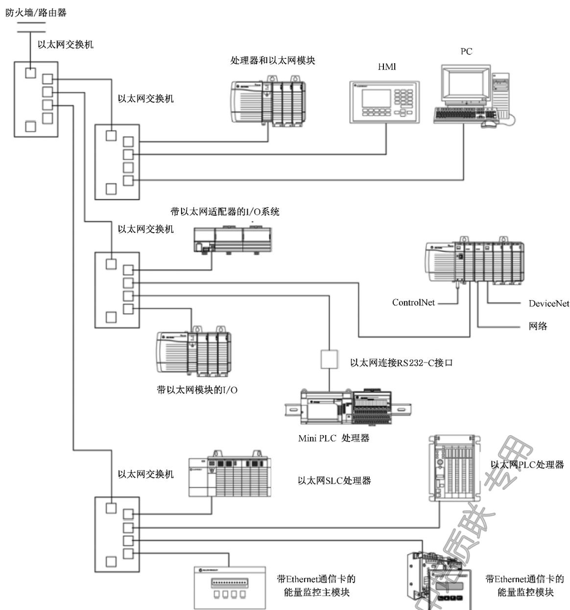
图 C.2 以太网结构的典型应用示例
