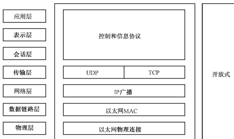
图 C.1 标准以太网七层模型
