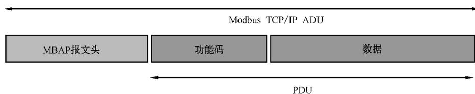
图 A.6 TCP/IP 上的 Modbus 请求/响应
