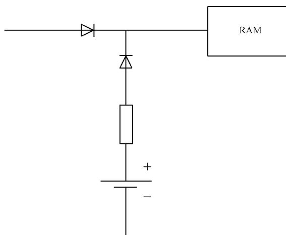
图 6 充电保护安全线路示意图
