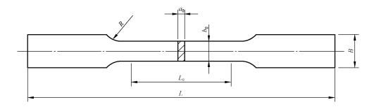
注:试样头部仅为示意性,可根据试验夹具自行设计。
