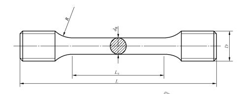
注: 试样头部仅为示意性,可根据试验夹具自行设计。
