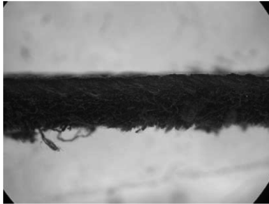
图 A.10 鹿皮革的纵截面结构形态图
