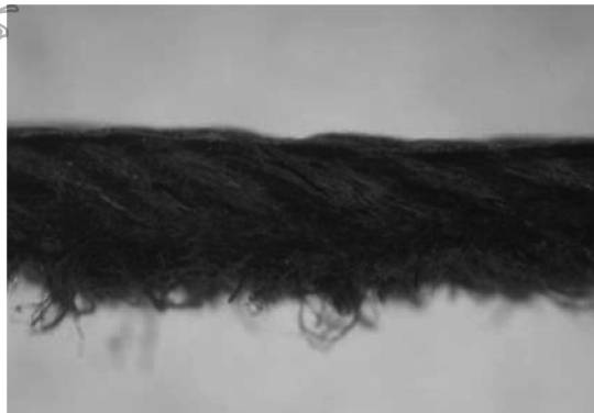
图 A.2 绵羊皮革的纵截面结构形态图
