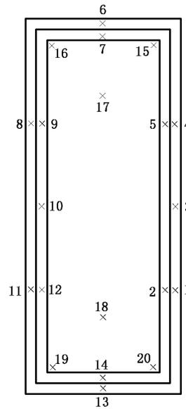
图 D.4 典型试件温度测点布置示意 4
