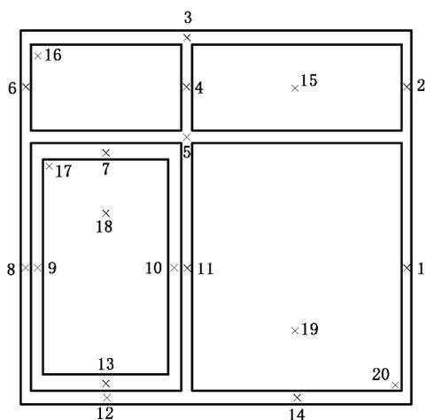
图 D.1 典型试件温度测点布置示意 1
