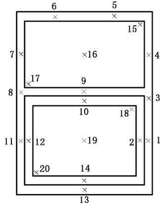
图 D.3 典型试件温度测点布置示意 3
