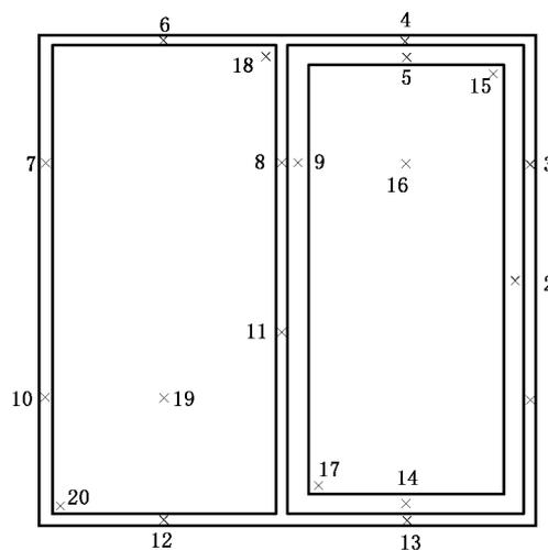
图 D.2 典型试件温度测点布置示意 2
