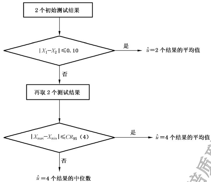
图 E.1 测试结果检查框图
