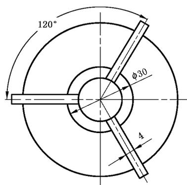
图 3 去污用搅拌叶轮俯视剖面图
