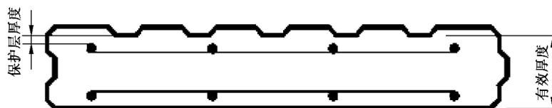
图 A.6 花纹板的有效厚度和保护层厚度
