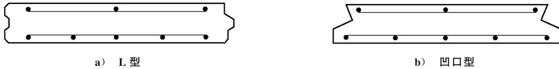
图 A.2 屋面板和楼板的典型断面和配筋示意
