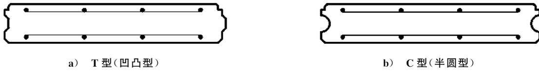
图 A.3 外墙板的典型断面和配筋示意
