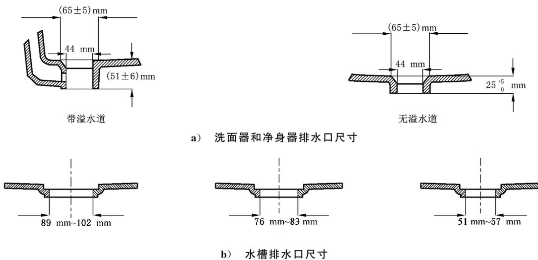
图 B.5 洗面器、净身器和水槽排水口尺寸示意图
