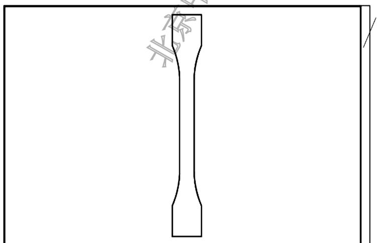
b) 在垂直于熔体流动方向获取试样
