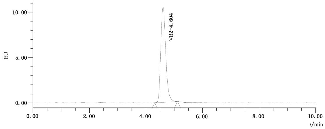
图 B.1 维生素 B<sub>2</sub> 标准溶液的液相色谱图
